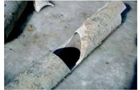
Das Eternitrohr DN 200 hielt dem Druck des Bodenfrostes nicht stand.
